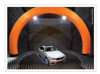
SG 3000シリーズのターンテーブルは、自動車のテスト用に設計されています。高精度なポジショニングシステム(コントローラーとターンテーブル)により、連続したリアルタイム測定が可能です。約15種類の周波数の指向性、利得、効率を3分以内(1回転にかかる時間)で測定することができます。(ターンテーブルおよび周波数に因る。)
