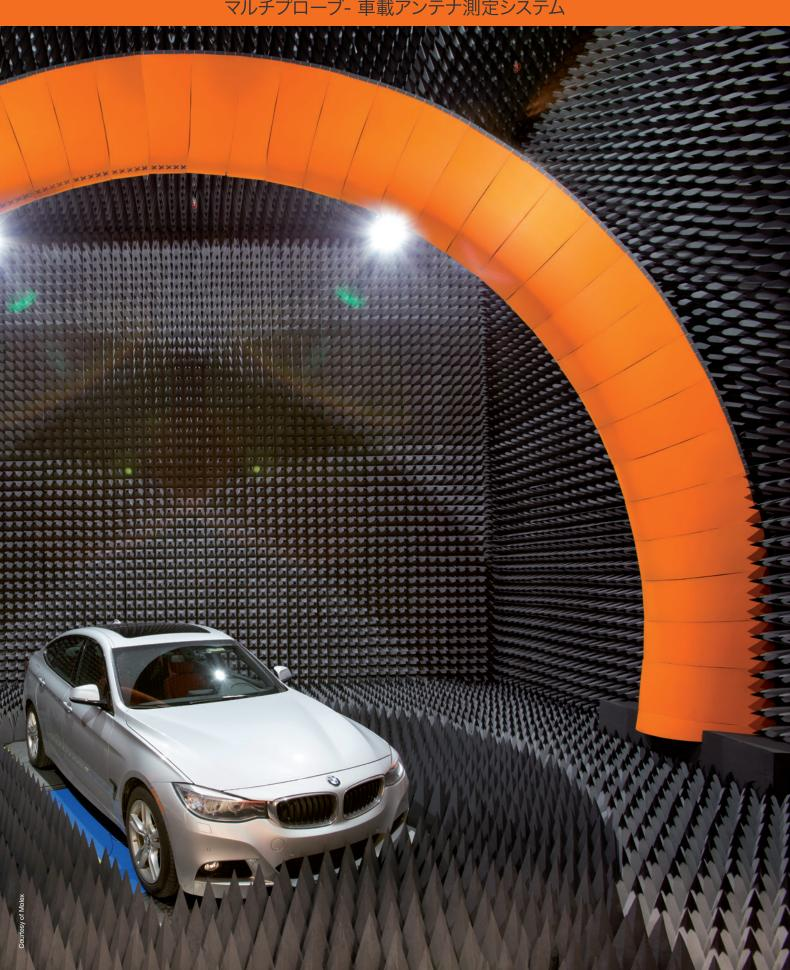
SG3000は、フルサイズの自動車用アンテナ測定やOTAテスト用のシステムです。お客様のニーズや設置条件に合わせてシステム構成を変更することができます。固定式(Fモデル)または移動式(Mモデル)の異なるサイズのアーチを設計することができますので、電波暗室に常設することも、電波暗室に移動させることも可能です。被測定物の回転を高精度な位置決めシステムで制御することで、離散的または連続的なリアルタイム測定が可能です。
